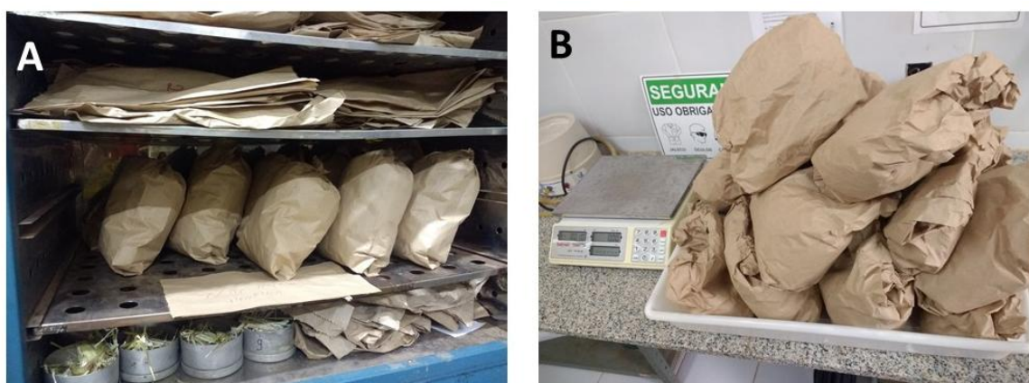
Figura 9 - Secagem das amostras em estufa por 48 horas (A) e pesagem das amostras para quantificar a massa seca (B).
