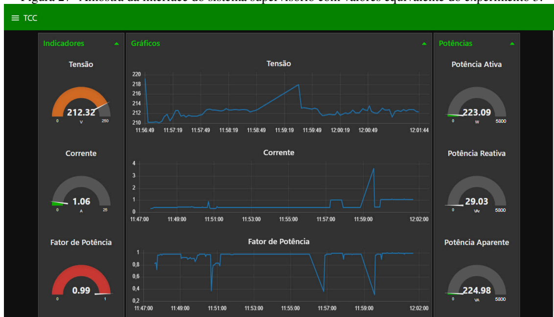
Figura 27- Amostra da interface do sistema supervisor com valores equivalente do experimento 3.
