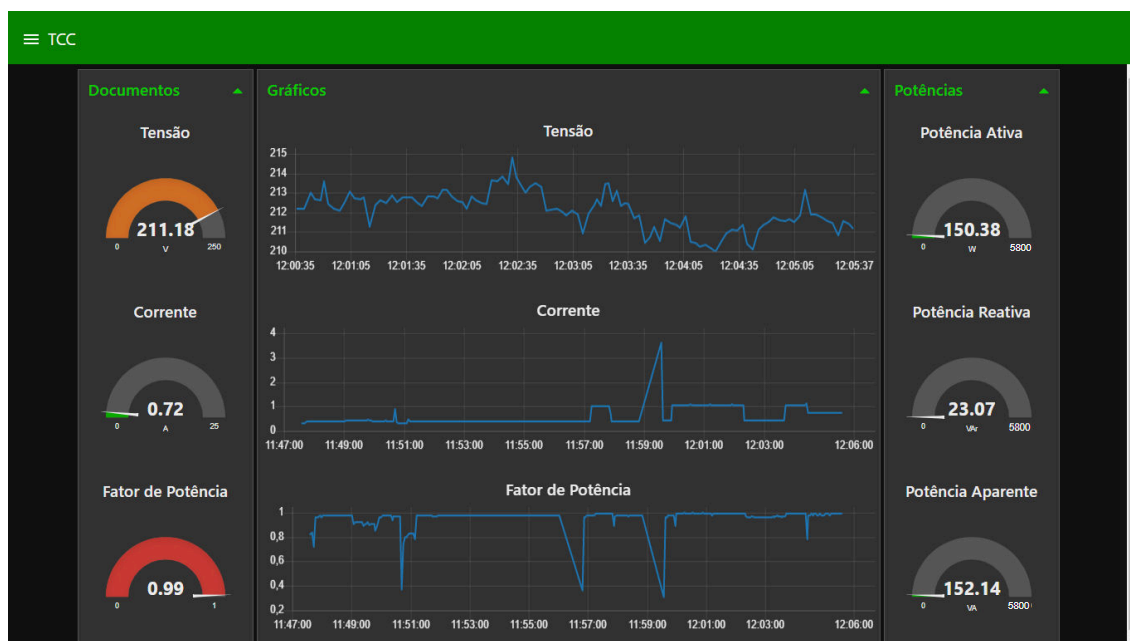
Figura 23-Amostra da interface do sistema supervisor com valores equivalente do experimento 1.
