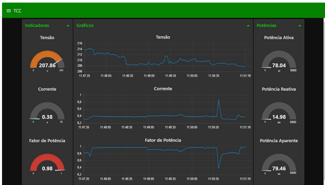
Figura 25-Amostra da interface do sistema supervisório com valores equivalente do experimento
