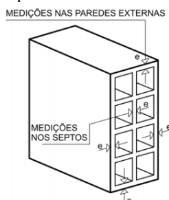
Figura 5 – Posições para medir a espessura das paredes externas e septos.
