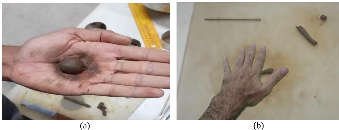
Figura 10: Ensaio de Plasticidade. (a) Moldagem da amostra em forma esférica; (b) Moldagem da amostra em forma cilíndrica
