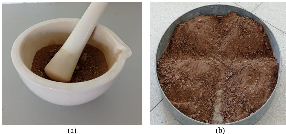
Figura 9: Preparação do solo. (a) Destorroamento; (b) Homogeneização e quarteamento.
