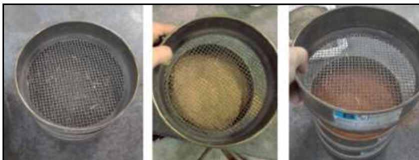
Figura 15 - Peneiramento dos solos A, B e C, respectivamente, na peneira ABNT de nº4 (4,8mm).
