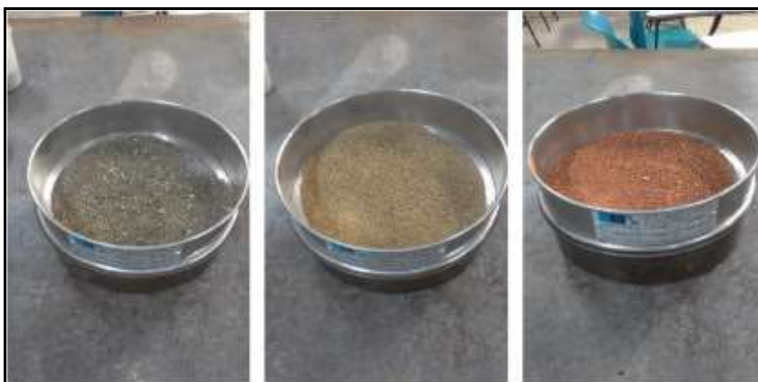
Figura 16 - Peneiramento dos solos A, B e C, respectivamente, na peneira ABNT de nº10 (2,0mm).
