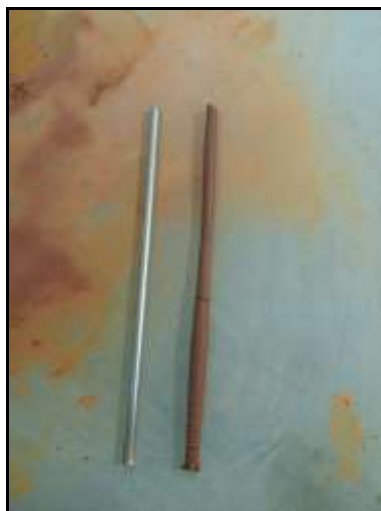
Figura 20 - Ensaio para a determinação do limite de plasticidade (LP).
