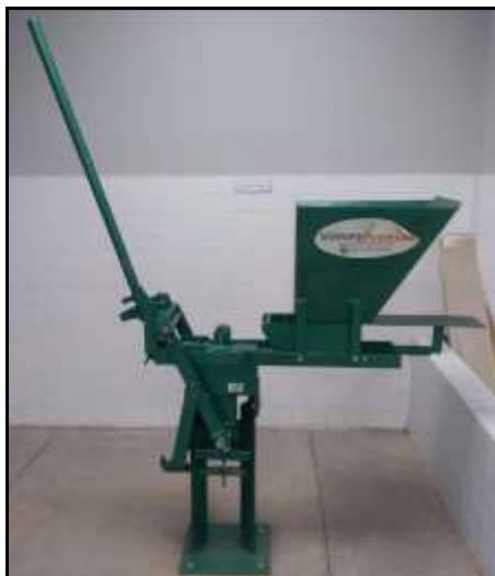
Figura 25 - Máquina de prensa mecânica para a fabricação de tijolos de solo-cimento.
