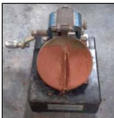
Figura 19 - Ensaio para a determinação do limite de liquidez (LL).
