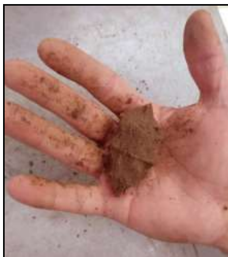
Figura 24 - Método da bolinha de solo, cimento e água.
