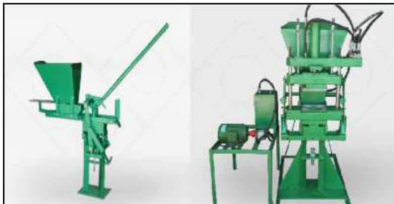
Figura 1 - Prensa manual e hidráulica de fabricação de tijolo de solo-cimento, respectivamente.
