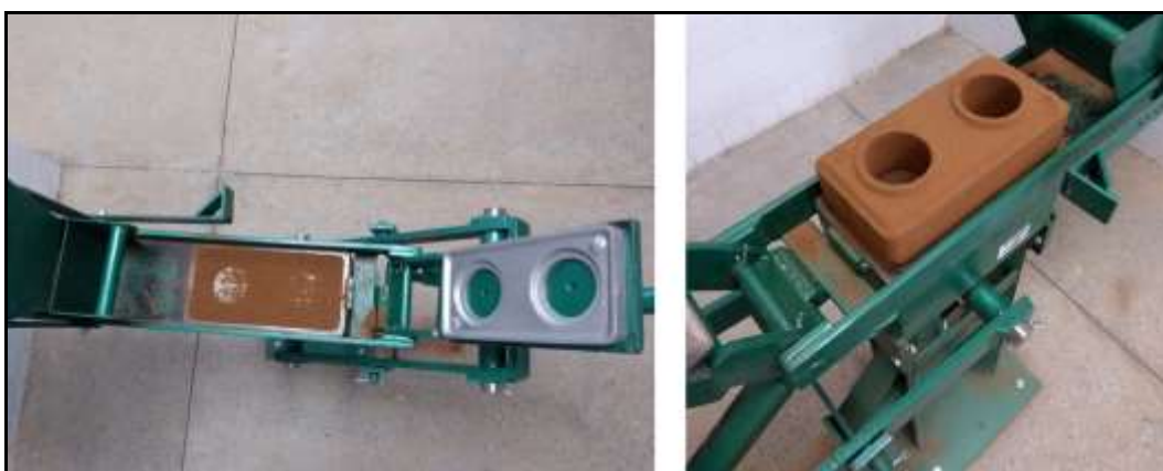
Figura 26 - Compactação da mistura pela máquina de prensas mecânica.
