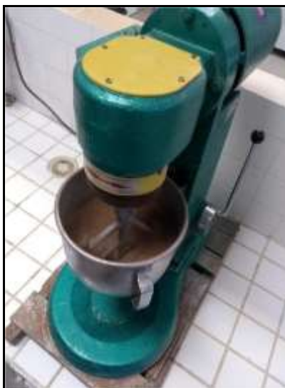
Figura 22 - Homogeneização dos materiais secos na argamassadeira.
