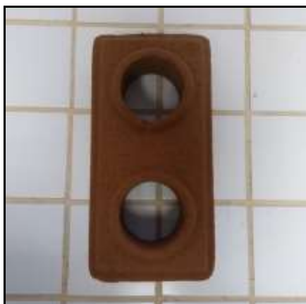
Figura 32 - Tijolo vazado de solo-cimento modulado com 6% de teor de água.
