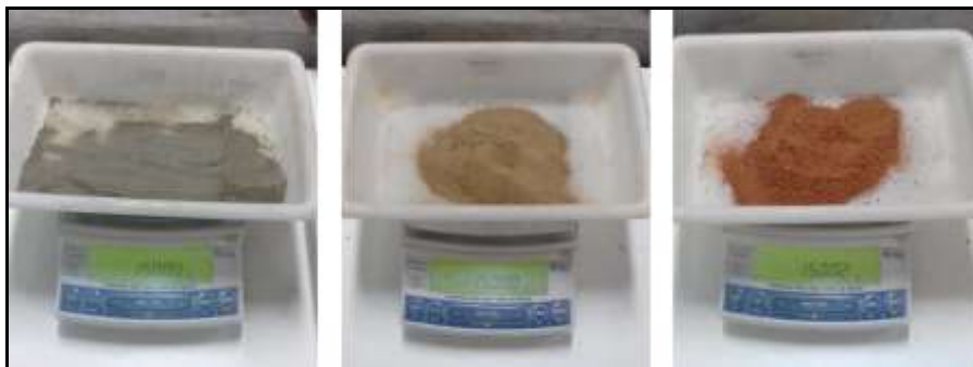
Figura 17 - Pesagem das amostras de solo para peneiramento fino: solo A, B e C, respectivamente.
