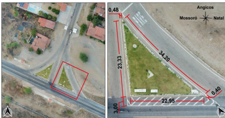
Figura 42 – Ilha canalizadora 2: dimensões e afastamentos com relação as vias em metros
