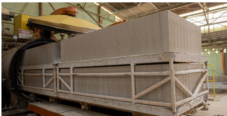
Figura 1: Autoclave para blocos celulares.
