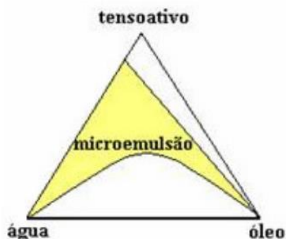
Figura 6. Diagrama ternário mostrando a zona de microemulsão em um sistema de três constituintes [20].
