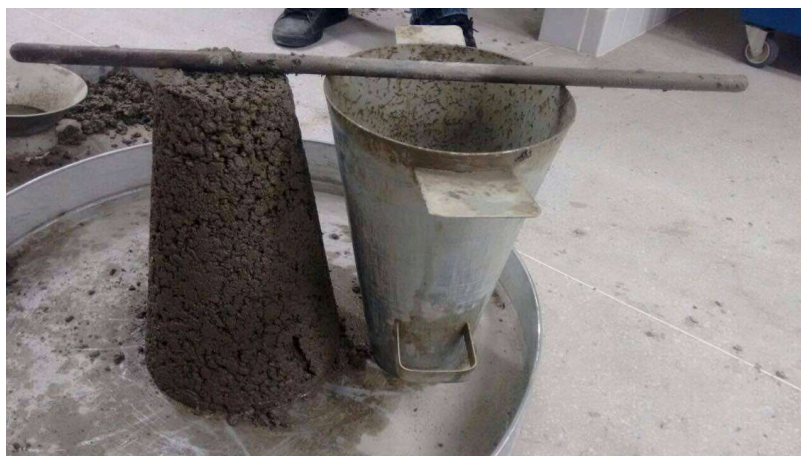
Figura 8- Determinação do abatimento do concreto com 60 % de pó de pedra
