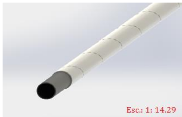
Figura 13 - Cano PVC montado no eixo
