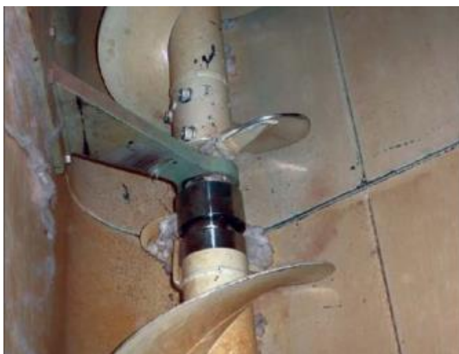
Figura 6 - Mancal de sustentação para evitar deflexão excessiva
