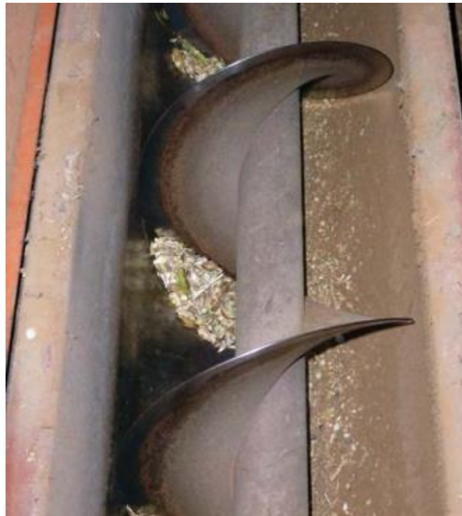
Figura 4 - Parafuso do transportador helicoidal e eixo motor
