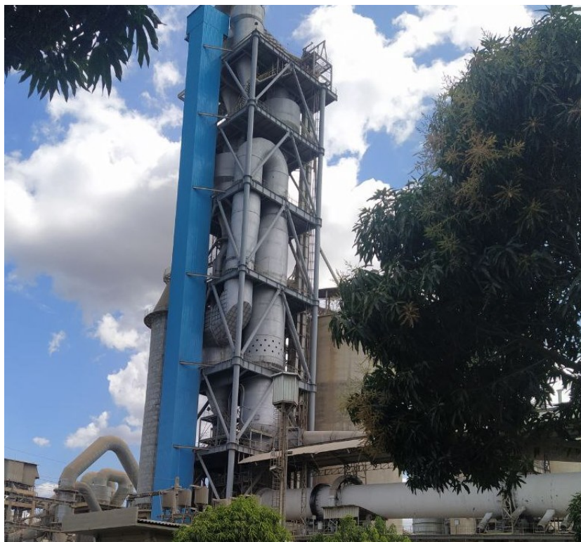
Figura 9 - Torre de ciclones e Calcinador
