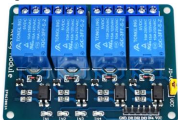
Figura 8 – Módulo relé 04 canais 5v 10a com led indicador
