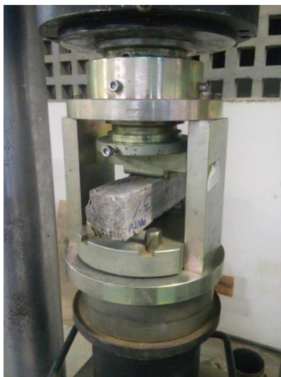
Figura 8 – Corpo de prova sendo rompido no ensaio de flexão na tração.
