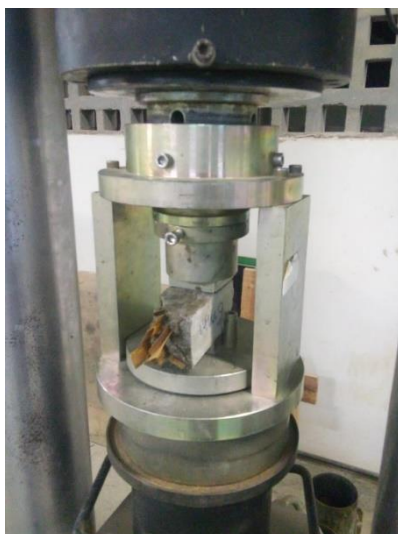
Figura 9 – Corpo de prova sendo rompido no ensaio de flexão na tração.
