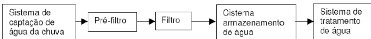
Figura 3- Esquema funcional do sistema cisterna
