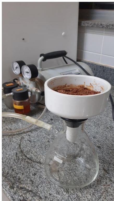
Figura 9 - Aplicação da sucção e coleta do filtrado.
