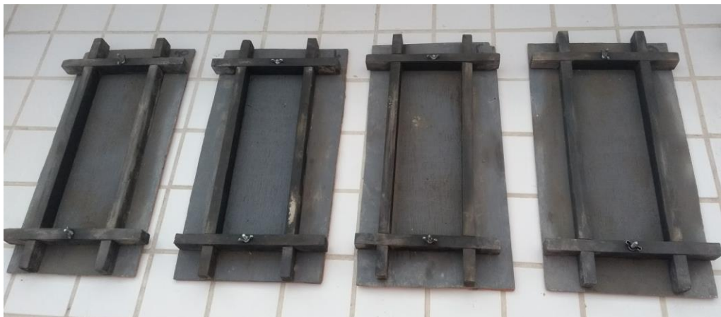
Figura 7. Fôrmas de madeira utilizadas.
