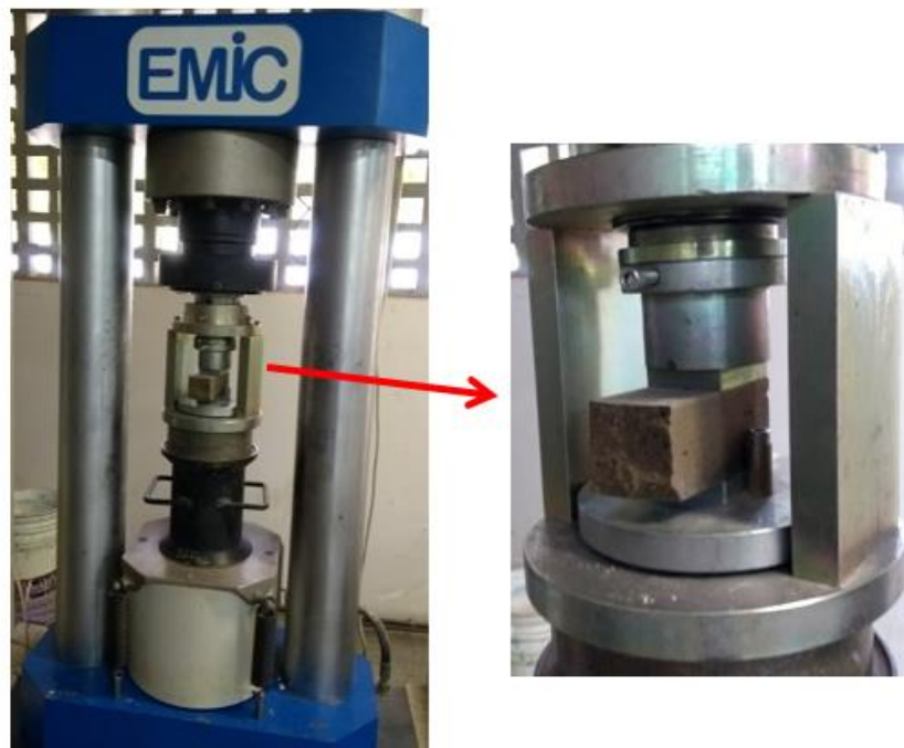
Figura 19. Ruptura dos corpos de prova - resistência à compressão.
