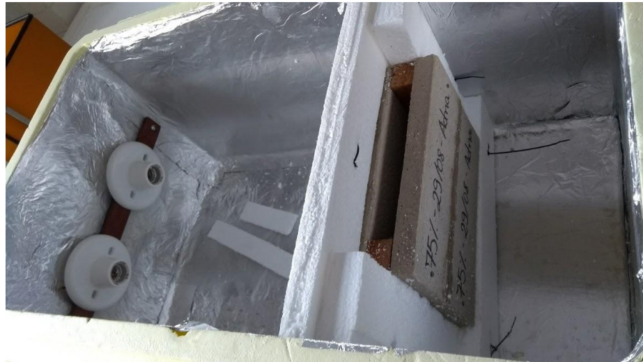
Figura 12. Posicionamento do painel de vedação no protótipo.
