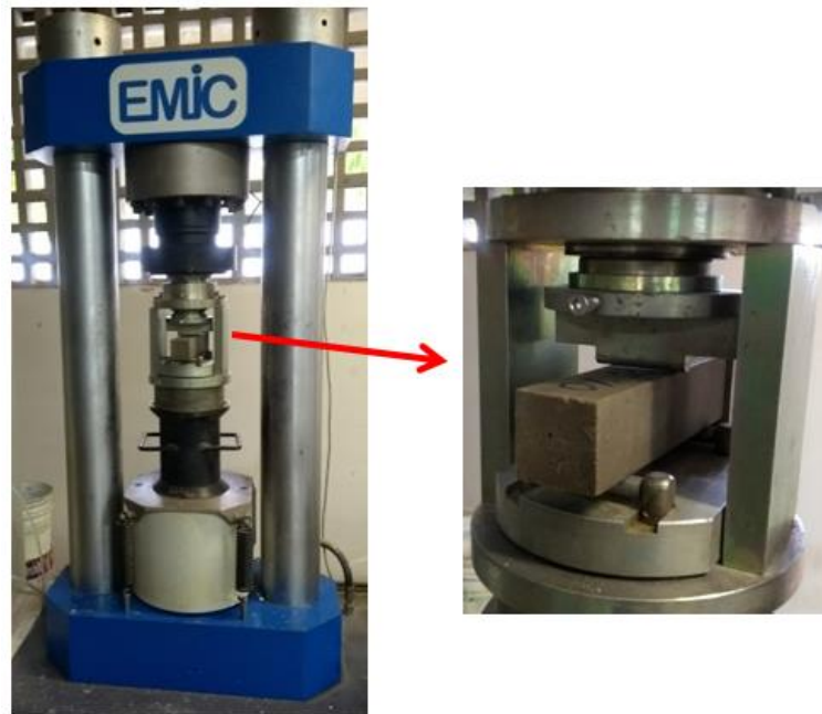
Figura 17. Ruptura dos corpos de prova - resistência à tração na flexão.
