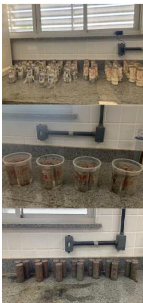
Figura 13: Moldagem e Desmoldagem dos CP's
