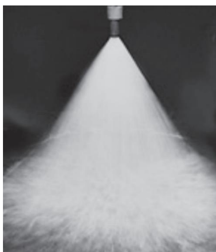
Figura 6 - Bico de atomizadores do líquido em um secador "spray dryer"
