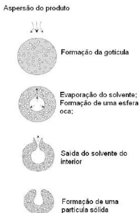
Figura 7 - Formação de partícula por secagem pelo método spray dryer
