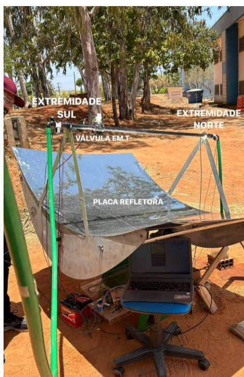
Figura 1. Estrutura e inclinação da calha. (Autoria própria)
