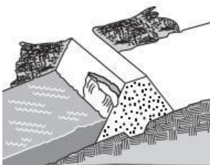
Figura 15: Escorregamentos no talude de montante
