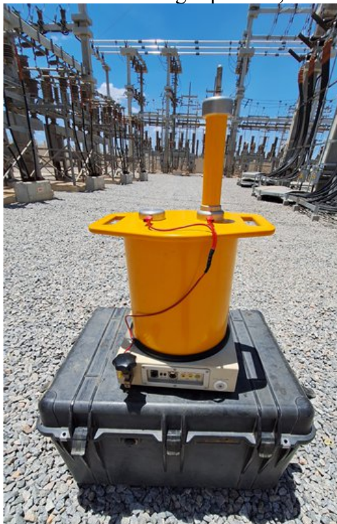
Figura 9 - Detector de descargas parciais, PD-TaD.
