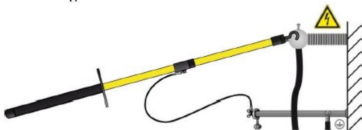
Figura 15 - Bastão de aterramento.
