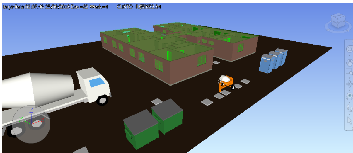
Figura 48 - Simulação da construção em dia de concretagem
