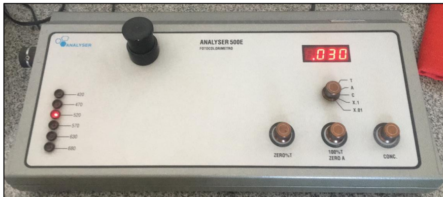
Figura 21 - Leitura da Absorbância em Fotocolorímetro Analyser.
