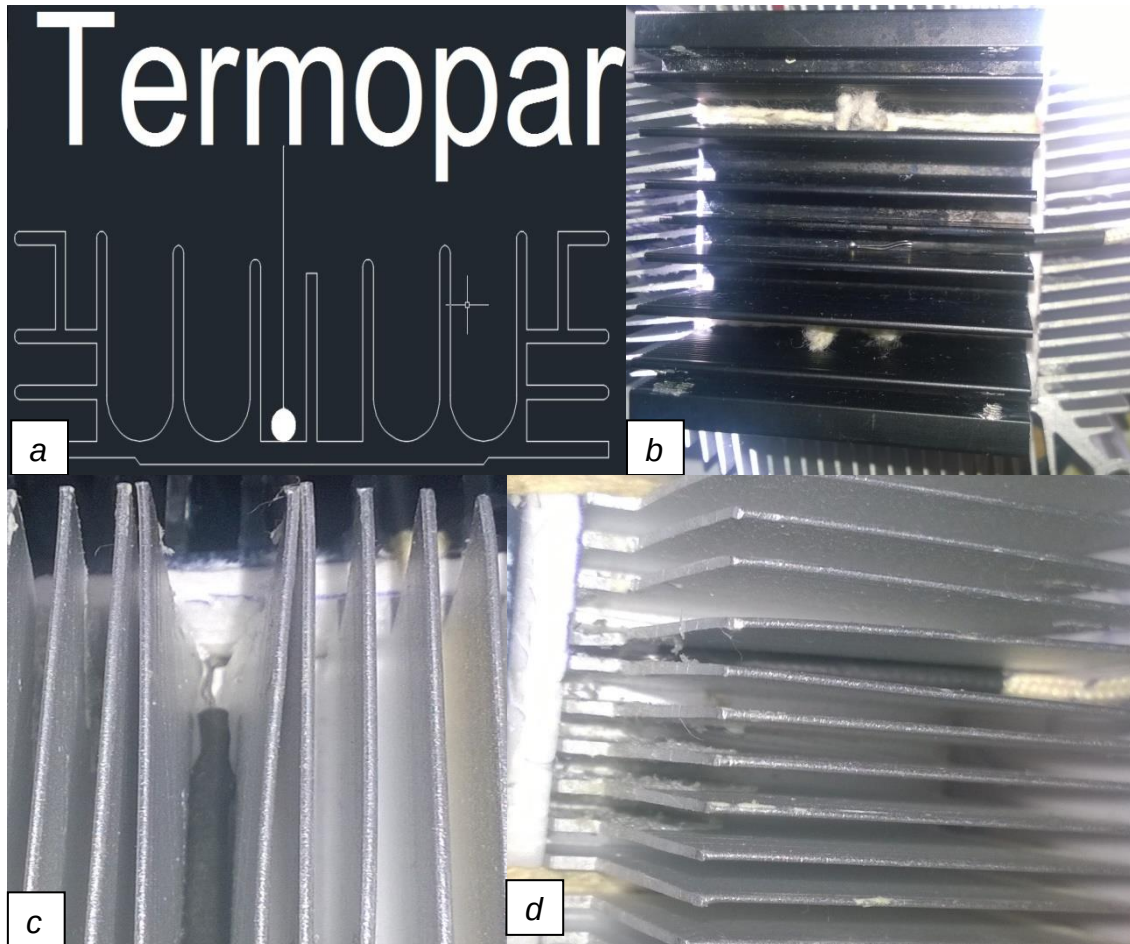
Figura 5.9 – a) Desenho da imagem frontal de como fica o termopar no dissipador interno; b) termopar no dissipador interno; c) A ponta do termopar em contato com o lado quente da placa peltier; d) Termopar fixado com as aletas do dissipador externo.
