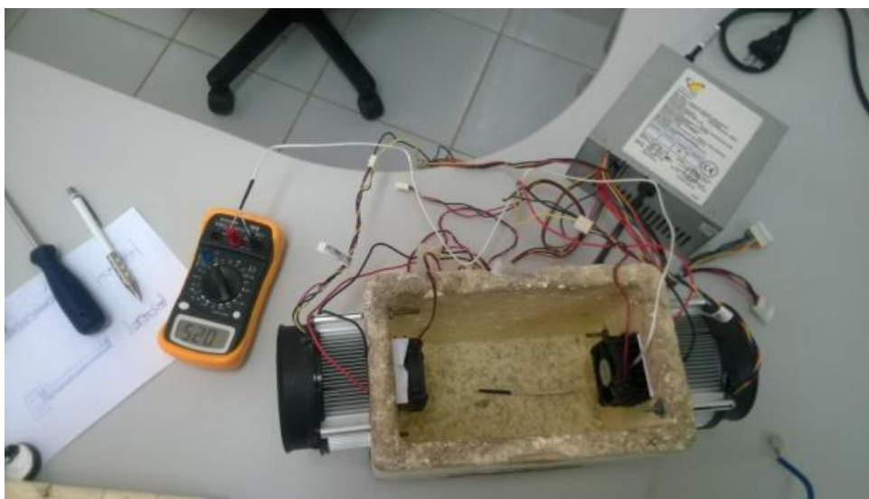
Figura 5.3 - Mini refrigerador montado e com termômetro para verificação das temperaturas atingidas.
