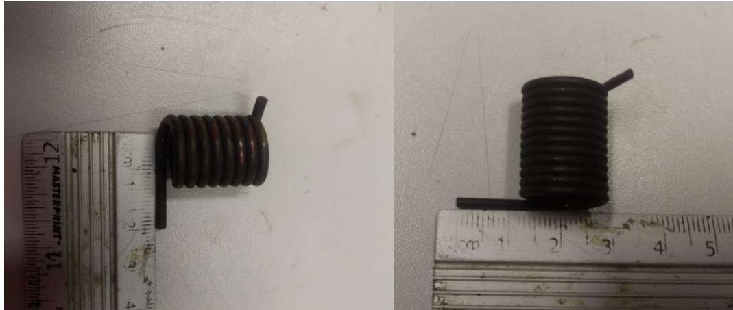
Figura 11 Molas Utilizadas no CVT Comet 780.
