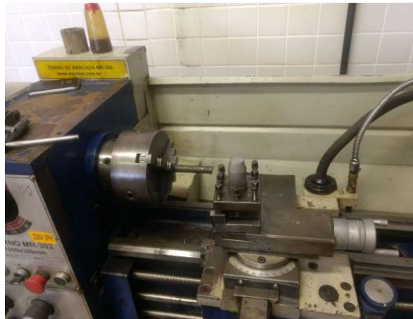
Figura 14 Eixo Sendo Usinado.
