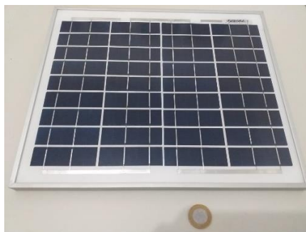
Figura 05 – Módulo fotovoltaico (comparativo de tamanho com moeda). (autoria própria,2021)
