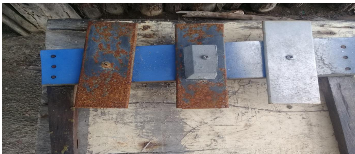
Figura 7. Barras expostas no ar após 40 dias (Autoria própria)
