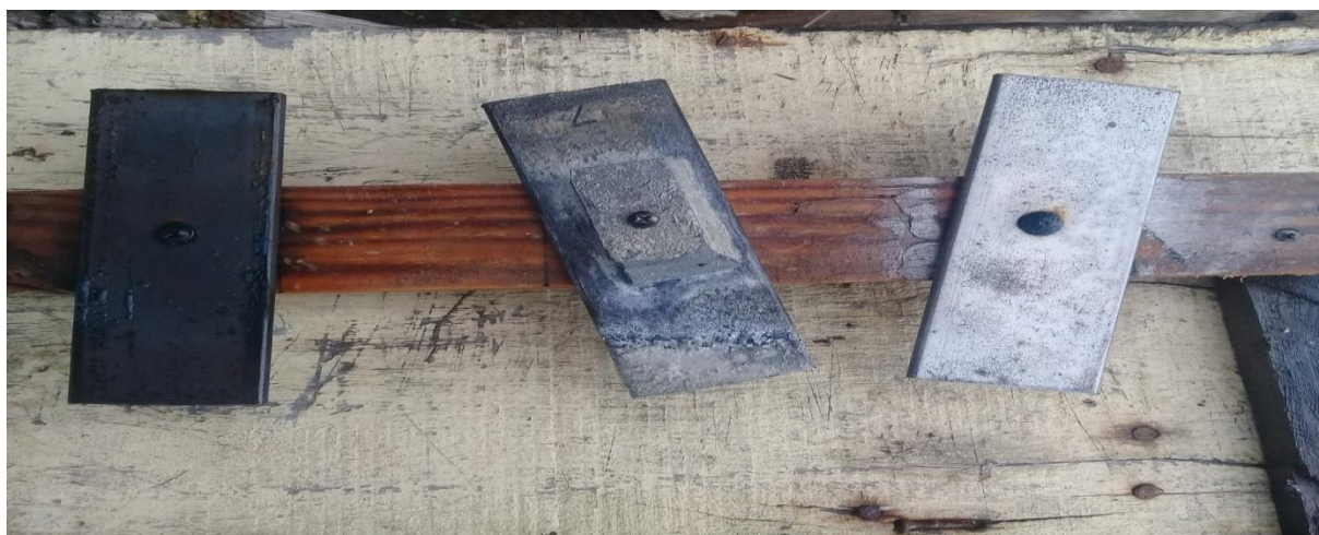
Figura 8. Barras imersas na água após 40 dias (Autoria própria)
