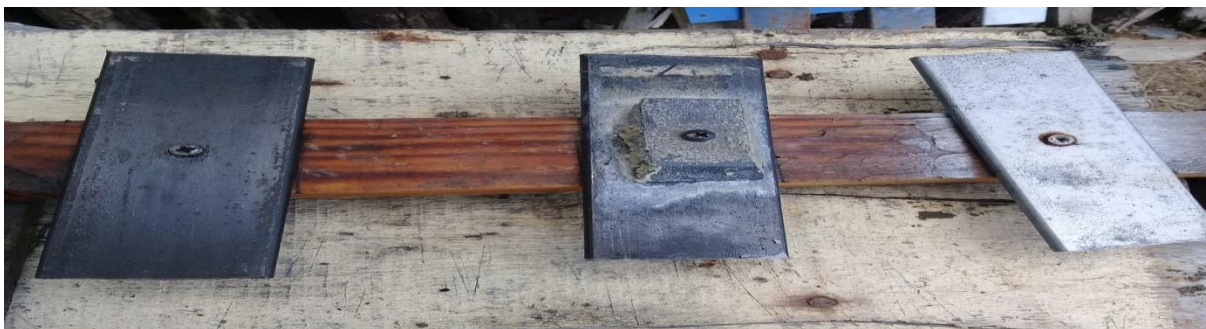
Figura 5. Barras imersas na água após duas semanas (Autoria própria)
