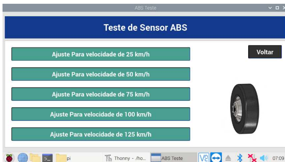
Figura 20 – Exemplo das velocidades que a bancada pode simular.
