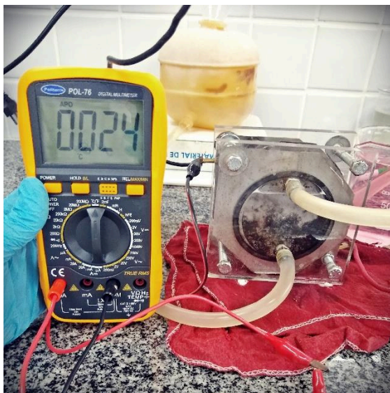
Figura 27 - Corrente consumida pelo o sistema utilizando a solução K_2SO_4 , 2,5 % de concentração.
