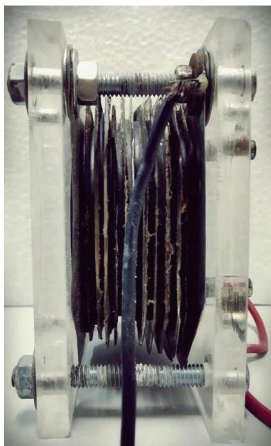
Figura 25 - Vista frontal do gerador de hidrogênio montado.
