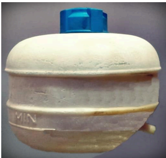
Figura 13 - Reservatório onde será armazenada a solução.
