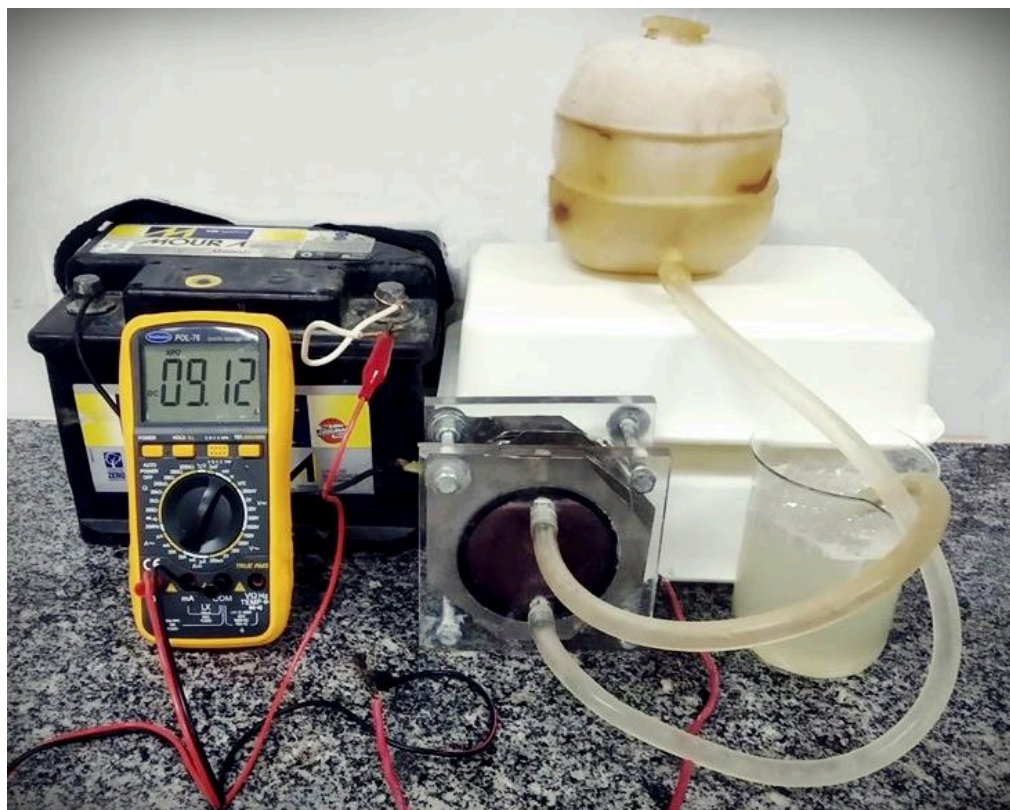
Figura 32 – Sistema utilizando uma bateria de carro como fonte de alimentação para o sistema, com solução na concentração de 50 % de NaOH.
