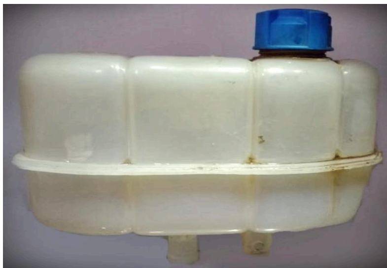
Figura 14 - Filtro utilizado na separação do gás com as bolhas.
