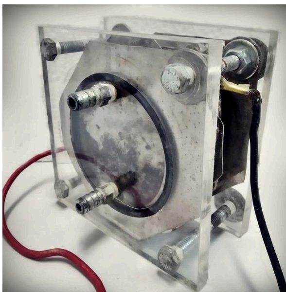
Figura 23 - Perspectivas do gerador de hidrogênio montado.
