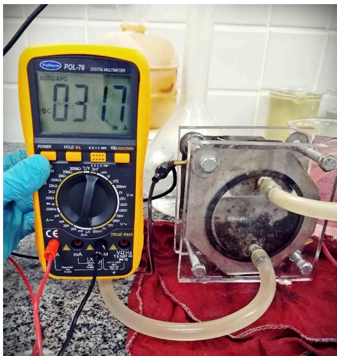
Figura 29 - Processo realizado para produção de hidrogênio e verificação da corrente utilizando \text{KNO}_3 2,5 % de concentração.
