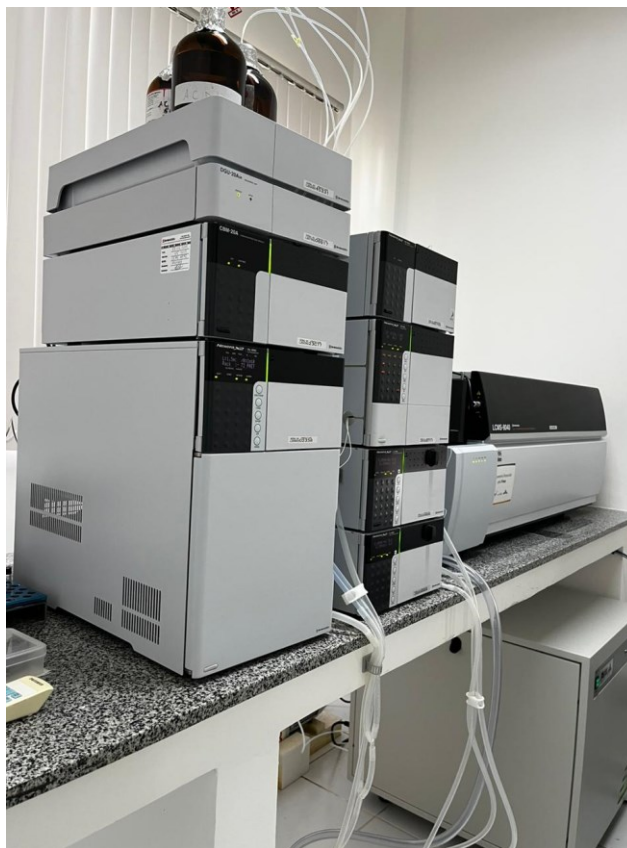
Figura 5: Aparelho de cromatografia líquida de alta eficiência, acoplada à espectrometria de massas (HPLC-MS/MS). Fonte: Acervo pessoal.
