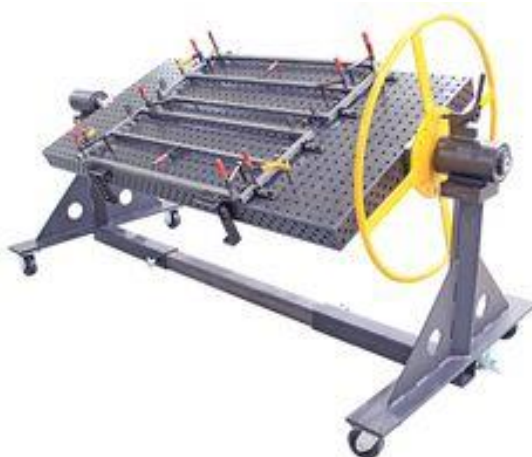
Figura 15 – Gabarito regulável para auxiliar a soldagem.
