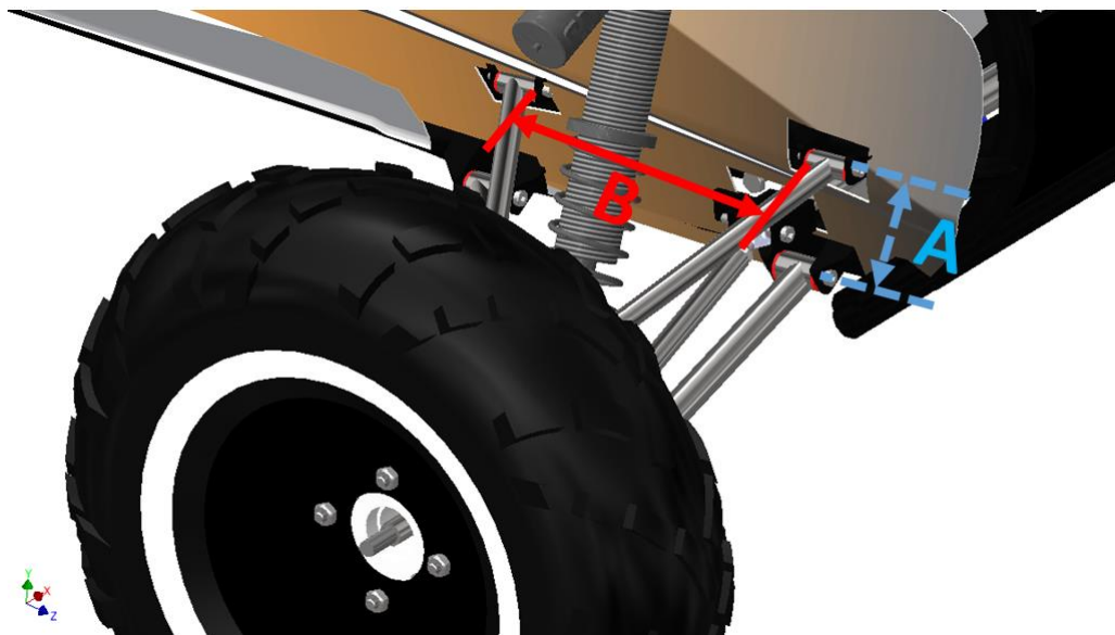
Figura 19 – Distância entre eixos das bandejas (A) e entre os olhais (B).
