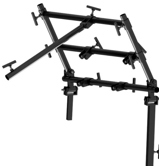
Figura 29 – Suporte para olhais (segundo sistema de regulagem) (5) aplicado ao software CAD/CAE.
