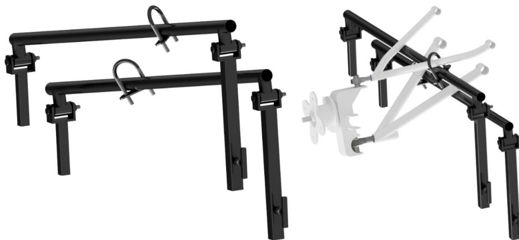
Figura 24 – Suporte para braços de suspensão (primeiro sistema de regulação) (2) aplicado ao software CAD/CAE.
