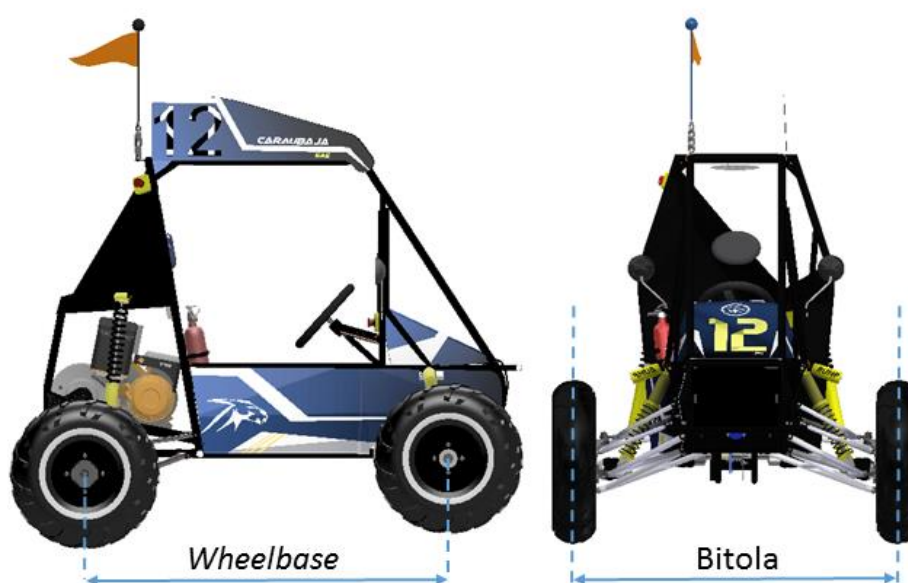
Figura 13 – Wheelbase e Bitola do protótipo SEVERO da equipe Caraubaja.
