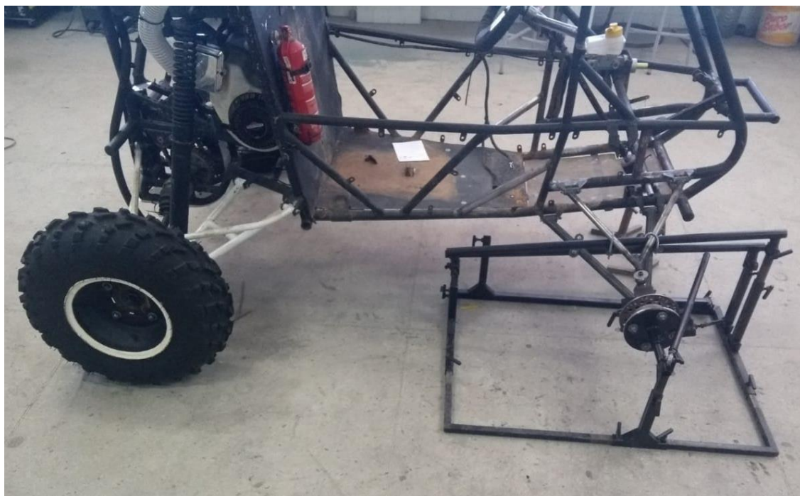
Figura 43 – Bancada posicionada com olhais prontos para ser soldados no chassi.
