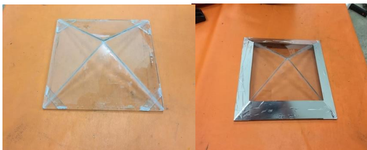
Figura 3 - Cobertura piramidal antes e depois das modificações.
