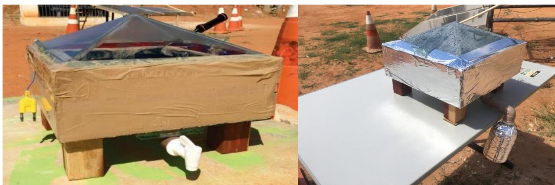
Figura 6 – Protótipo de dessalinizador solar antes e depois das modificações propostas.
