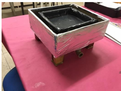
Figura 5 – Revestimento com fita adesiva espelhada.
