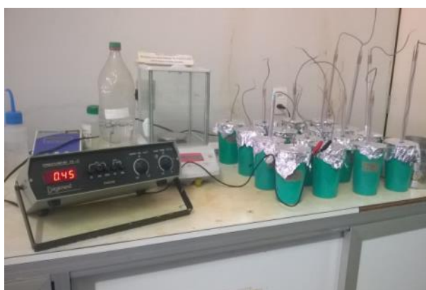
Figura 8. Detalhe da calibração dos sensores de condutividade elétrica do solo em pasta (solo mais solução)
