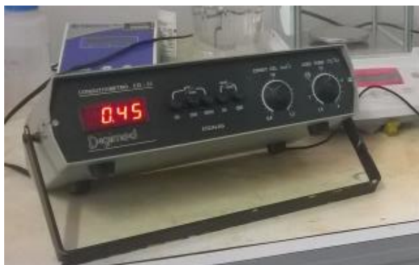
Figura 41. Sistema de aquisição das leituras: (A) sensor de condutividade elétrica do solo montado; (B) condutivímetro utilizado para realização das leituras de condutividade elétrica
