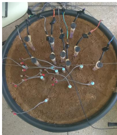
Figura 13. Disposição dos tensiômetros e sensores de condutividade elétrica no solo
