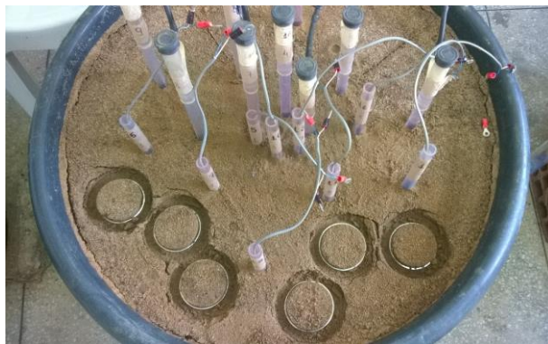
Figura 14. Detalhe da coleta das amostras indeformadas
