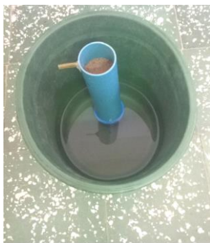
Figura 16. Procedimento de saturação da coluna de solo, por capilaridade, com água destilada, para elaboração das curvas de distribuição de efluentes
