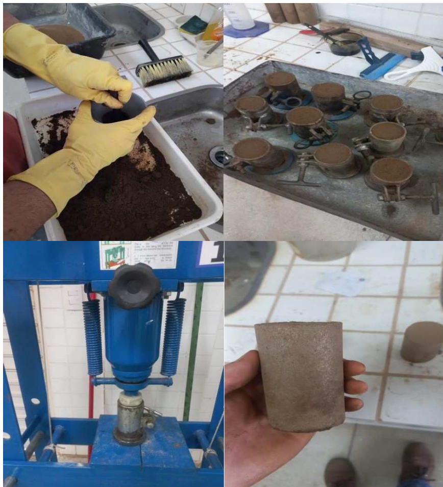
Figura 7 - Processo de compactação e prensagem dos corpos de prova
