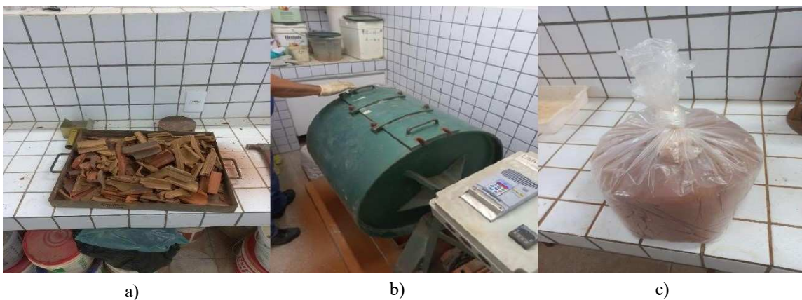
Figura 4 - Preparo do resíduo cerâmico: a) resíduo graúdo; b) máquina de abrasão Los Angeles; c) material ensacado
