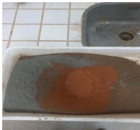
Figura 6 - Mistura seca do solo, cimento e RCV
