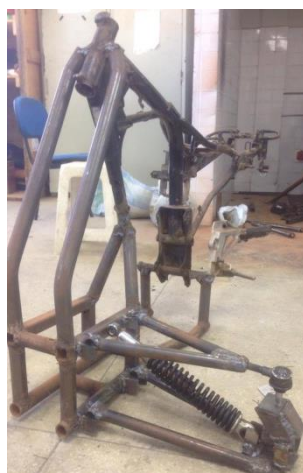
Figura 10.1 – Estrutura final de suspensão soldada e acoplada ao chassi
