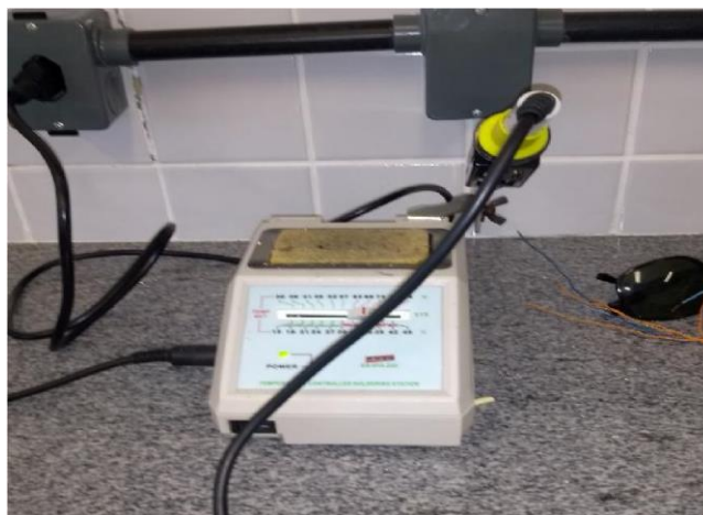
Figura 12: Estação de solda
