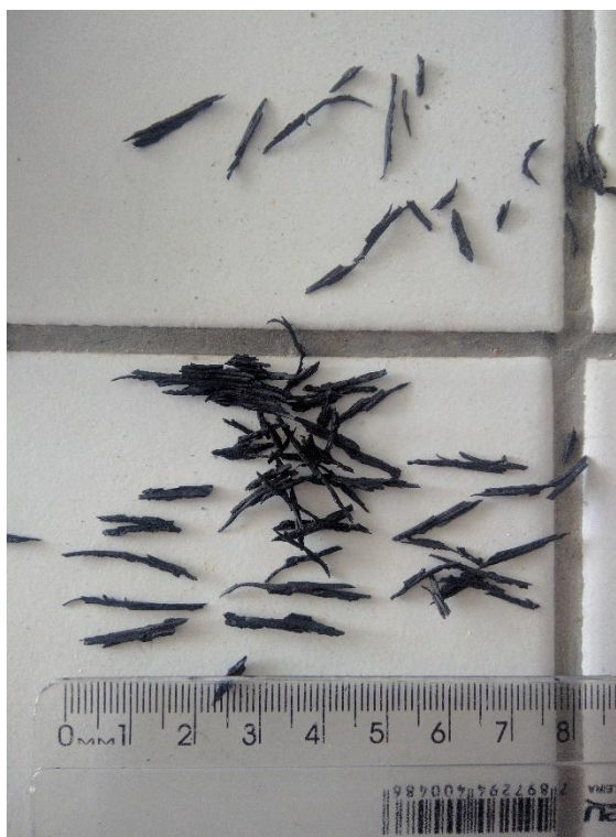
Figura 4 – Fibra de borracha de pneu adicionada na composição do concreto.
