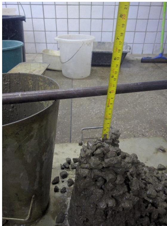
Figura 8 – Ensaio de Slump Test .
