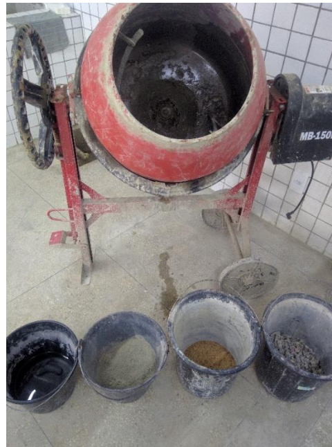
Figura 5 – Betoneira usada para mistura do traço de forma mecânica.
