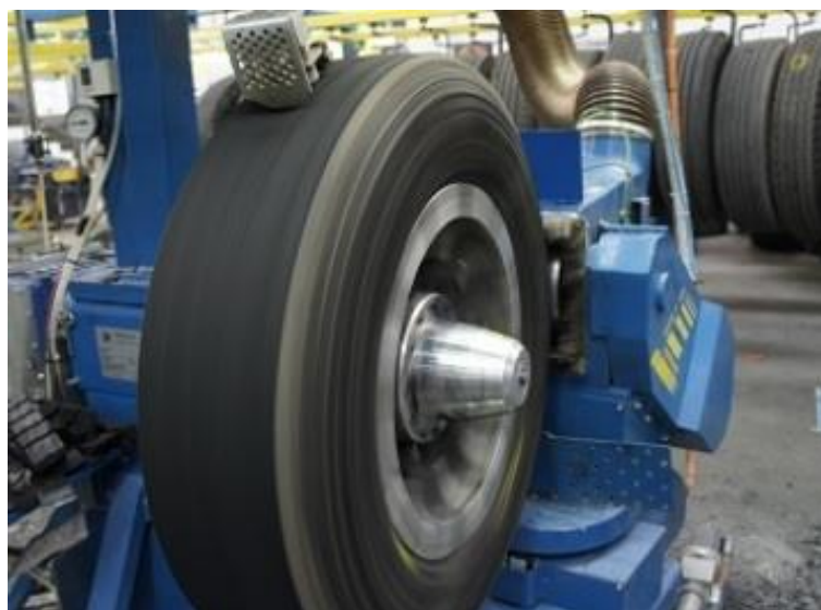
Figura 2 – Processo de raspagem, uma das etapas da recauchutagem de pneu.
