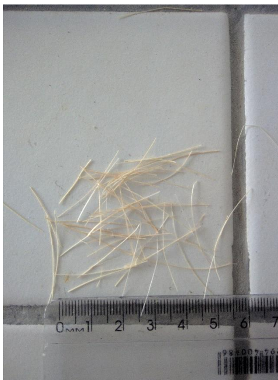
Figura 3 – Fibra de sisal adicionada na composição do concreto.
