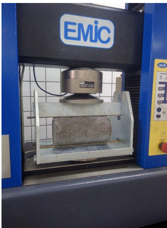
Figura 9 – Ensaio de tração por compressão diametral.
