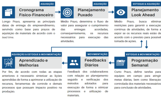
Fig. 4. Fluxograma da aplicação do LPS com foco na Gestão de Suprimentos.
