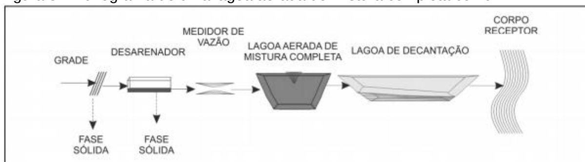
Figura 8 - Fluxograma de uma lagoa aerada de mistura completa comum.
