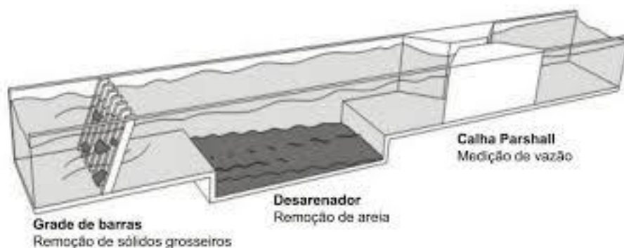
Figura 3 - Dispositivos do tratamento preliminar
