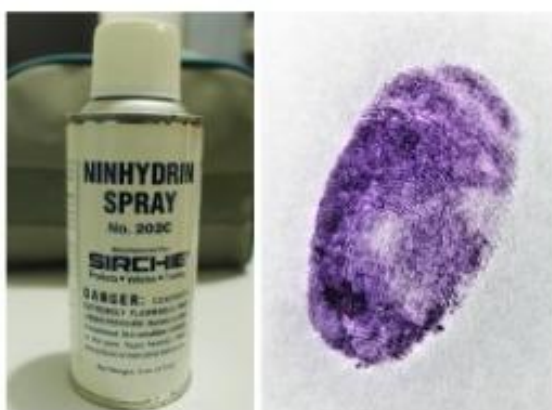
Figura 9: Impressão digital revelada com spray de solução etanólica de ninidrina
