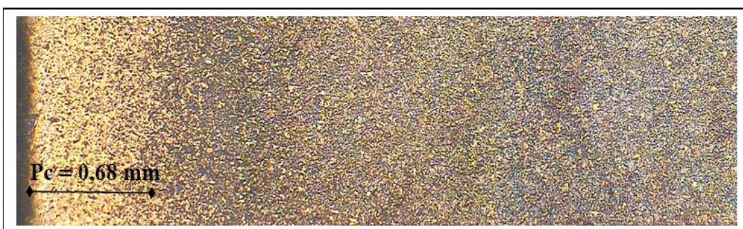
Figura 12. Camada cementada do aço SAE/ABNT 1020, tratado a 930 °C / 4 horas / 10,45% \text{CaCO}_3 [5].
