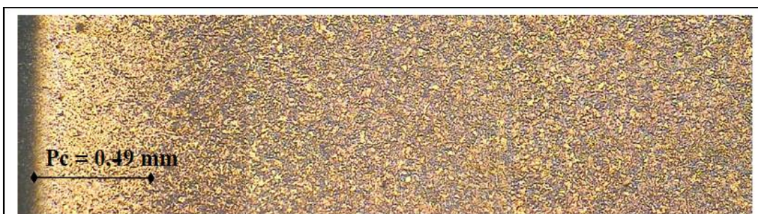
Figura 11. Camada cementada do aço SAE/ABNT 1020, tratado a 930 °C / 8 horas / 10,45% \text{CaCO}_3 [5].
