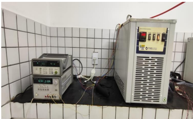
Figura 7 - Configuração do ensaio RET. (Autoria própria).
