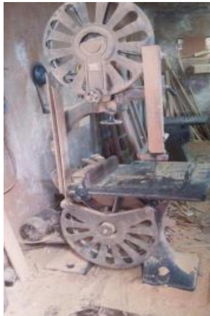
Figura 36 – Serra de fita existente na unidade que produz portas e esquadrias
