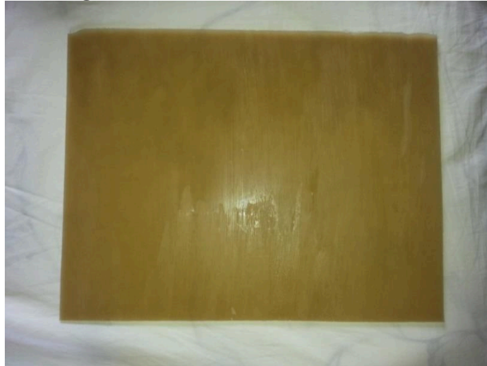
Figura 23 - Placa de calcário desmoldada.
