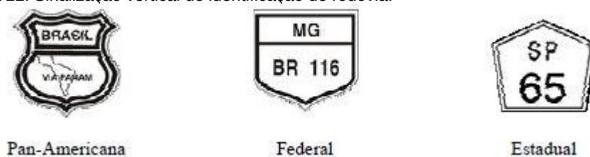
Figura 22: Sinalização vertical de identificação de rodovia.
