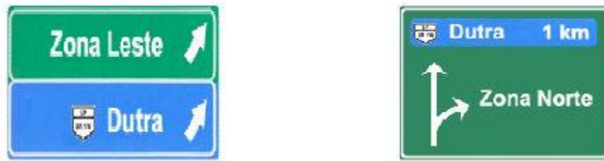
Figura 23: Sinalização vertical indicativa de sentido.
