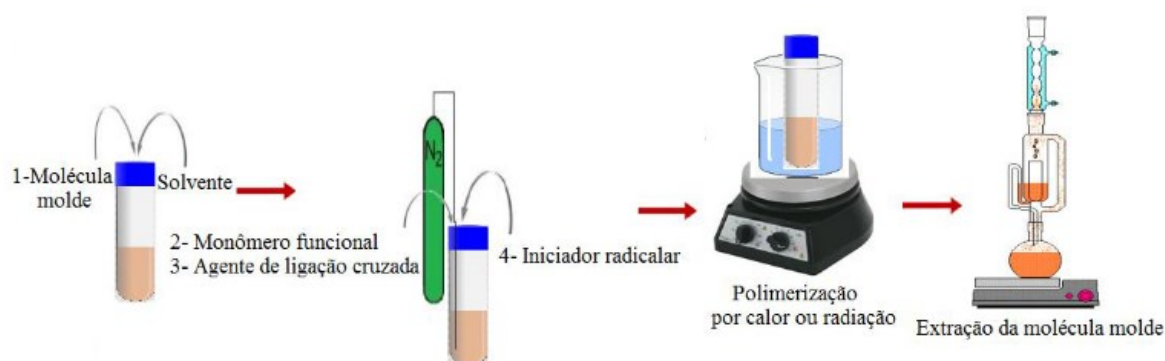
Figura 8 - Esquema da síntese do MIP via polimerização por radicais livres
