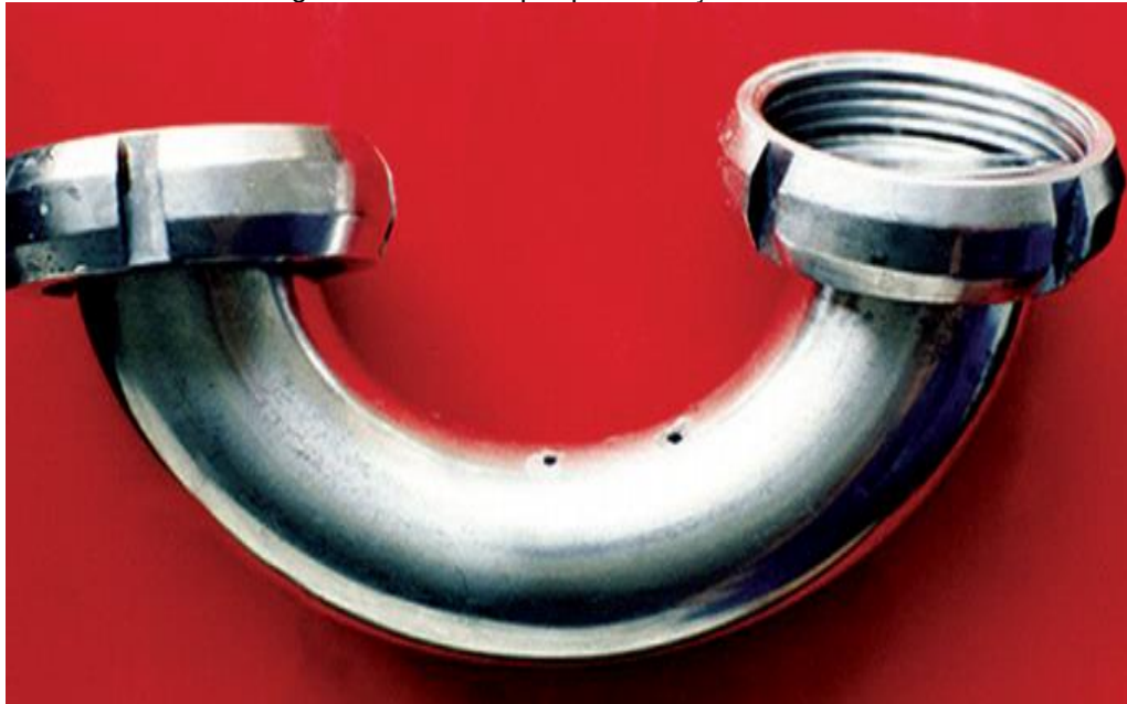
Figura 4: Corrosão por pite em aço inoxidável.
