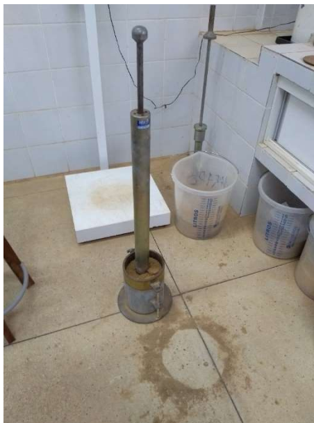
Figura 10: Processo de compactação do solo
