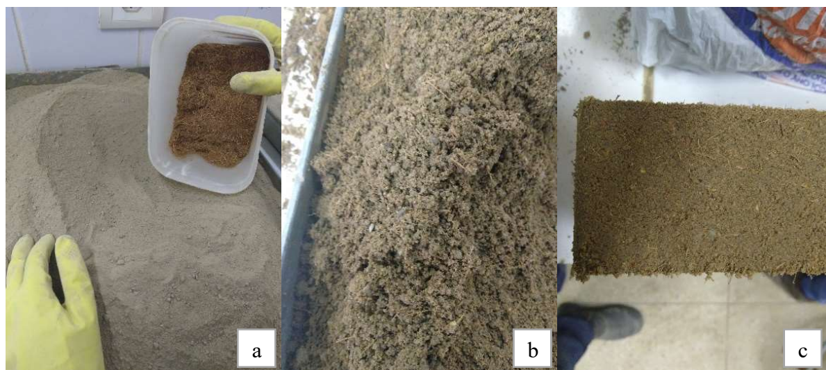
Figura 20: Confecção dos tijolos com fibra de coco triturada
