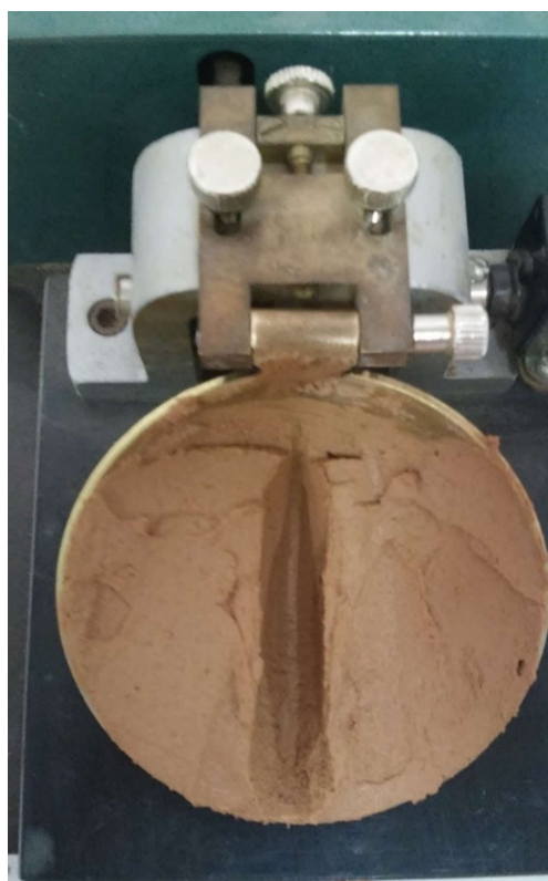
Figura 7: Massa de solo cortada no aparelho de Casagrande
