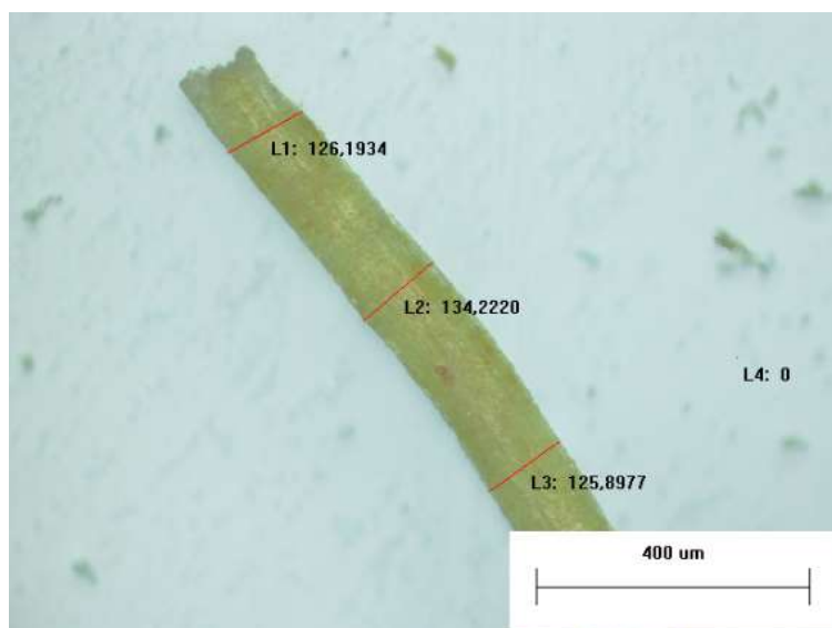
Figura 28: Medições realizadas ao longo da fibra aumentada em 100 vezes
