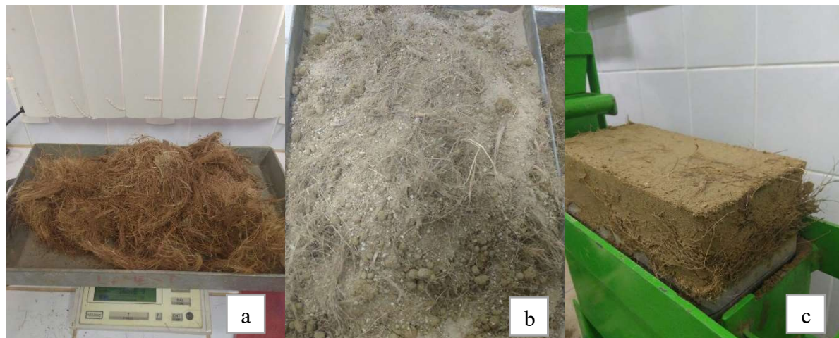
a) Fibras sem beneficiamento; b) Mistura homogeneizada com a fibra; c) Tijolo prensado (Fonte: Autoria própria, 2018)
