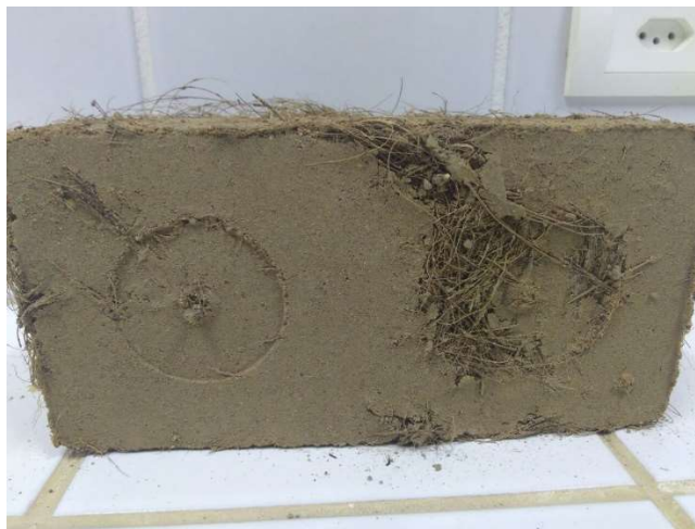
Figura 29: Tijolo apresentando não uniformidade da distribuição das fibras
