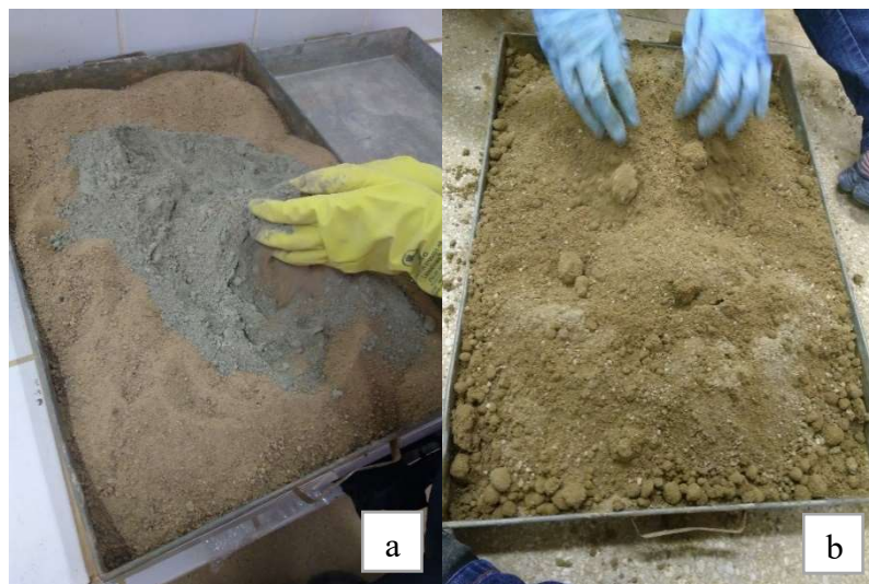
a) Adição de cimento ao solo; b) Mistura adicionada de água sendo homogeneizada. (Fonte: Autoria própria, 2017).
