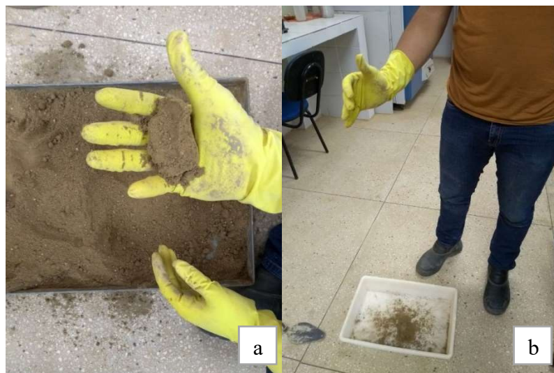
Figura 17: Testes de verificação da umidade
