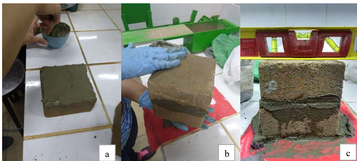
Figura 23: Processo de colagem dos tijolos
