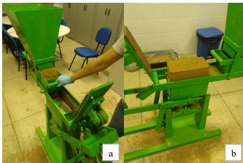
Figura 18: Prensagem dos tijolos
