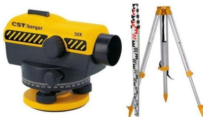
Figura 3. Aparelhos utilizados em nivelamento geométrico: nível de precisão, tripé de sustentação e mira topográfica, respectivamente.
