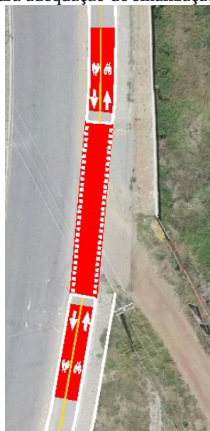
Figura 16 – Detalhe para adequação de sinalização em trechos em curvas
